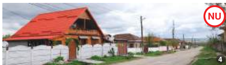
ASA NU: [2-4] Configurarea acoperișurilor în două ape, cu ruperi de pantă sau pante abrupte sau cu frontoane orientate către stradă, contrastează cu imaginea construcțiilor tradiționale, cu acoperișuri în patru ape, cu pante puțin abrupte.
