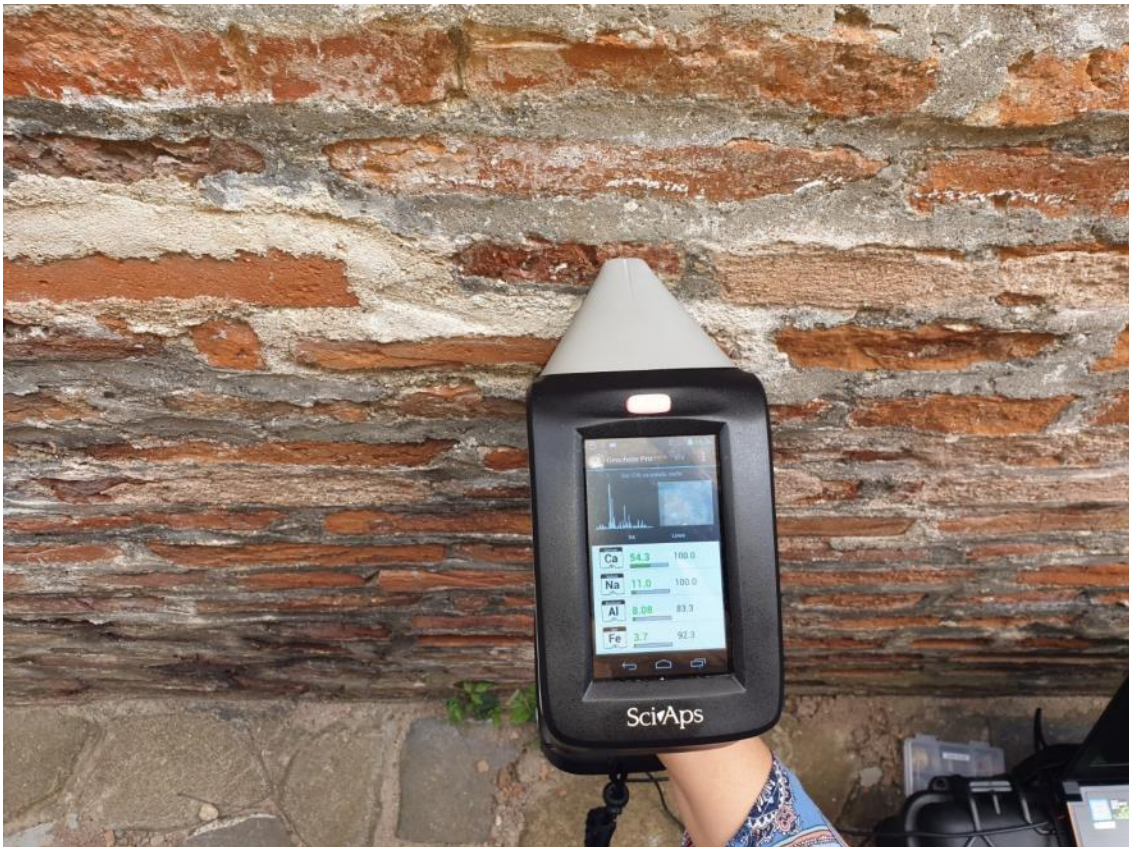
Scanări și analize în vederea realizării unor metode eficiente de conservare a monumentelor istorice.
