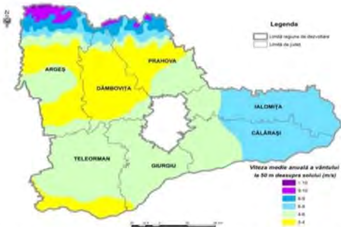
Figura 2.132. Potențialul eolian în regiunea Sud Muntenia. Sursa: Studiu privind stadiul actual de dezvoltare al infrastructurii în Regiunea Sud-Muntenia și perspective de dezvoltare.
